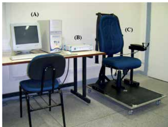
Figura 1. Sistema de aquisição: (A) computador, (B) sistema de aquisição e condicionamento de sinais modelo SPIDER 8 e (C) estação de medição de força.
